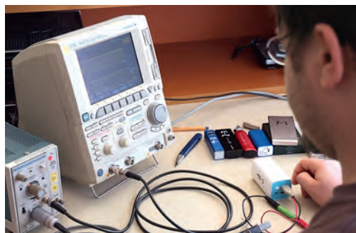
Testlabor: Kurzschlussstest (oben), Kapazitätsmessung im Wärmeschrank bei 40 Grad (rechts)
