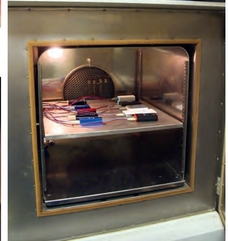
Testlabor: Kurzschlussstest (oben), Kapazitätsmessung im Wärmeschrank bei 40 Grad (rechts)
