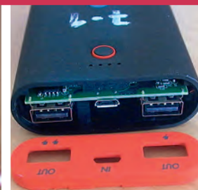
Das Innere: Geöffnetes Gerät (links), Gerät mit abgelöstem rotem Seitenteil nach Falltest
